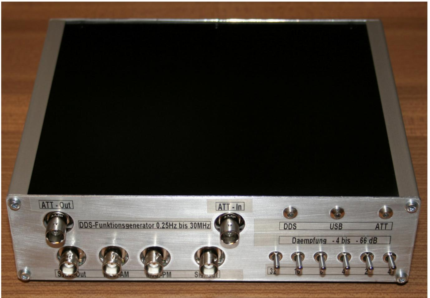
Als DDS-Generator kommt ein Bausatz von „ELV – Elektronik“ zum Einsatz, ( DDS 130 ) es ist eigentlich gar kein Bausatz, da fast alle Bauelemente schon bestückt sind. Der größte Teil des Abgleichs erfolgt via Software und ist somit auch kein Problem.
