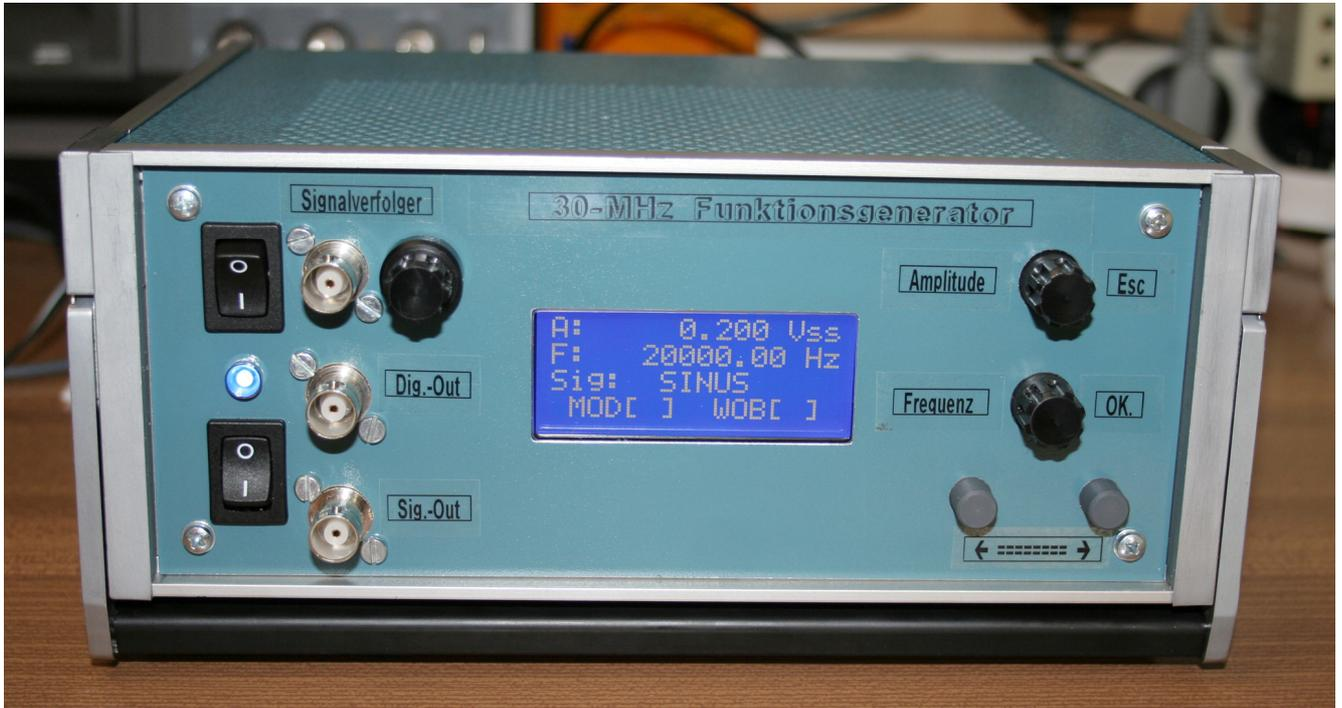
Um noch ein zusätzliches Gerät für NF-Messungen einzusparen, wurde auch gleich noch ein NF-Signalverfolger ( kleiner NF-Verstärker ) mit eingebaut. So kann das Generatorsignal, wenn es die am Funktionsgenerator angeschlossene und zu testende Schaltung passiert hat, auch mal akustisch beurteilt werden.
