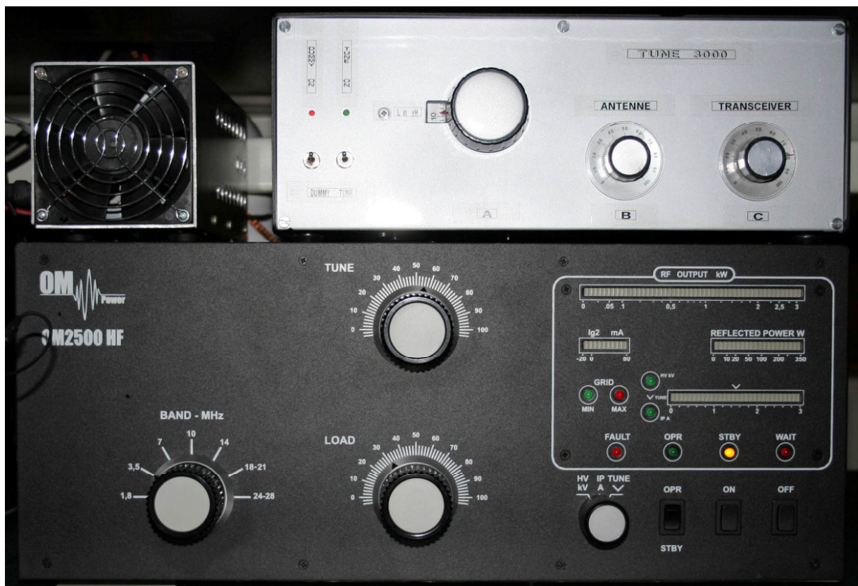
Links im Bild der Eigenbau Dummy mit Lüfterkühlung
